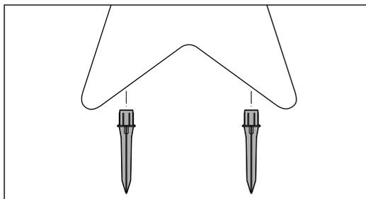
▷ Insérez les piquets jusqu'à la butée dans les deux ouvertures prévues à cet effet sous le luminaire.
