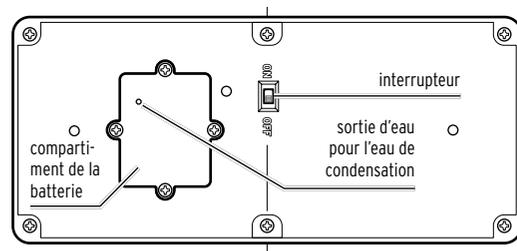
▷ Pour allumer le luminaire, poussez l'interrupteur sur **ON**.
